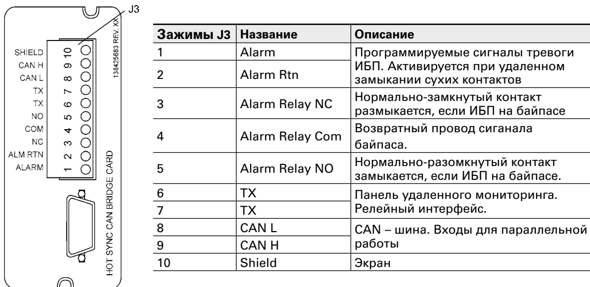
Рисунок 50. Плата XSlot Hot Sync и контактный интерфейс
